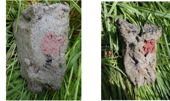
Figure 9 : Exemple du précipité rouge de la réaction du test à la phénanthroline
